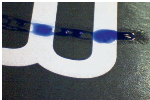
Benetzung mit Testtinte (38 mN/m) auf Primerlack über druckfreien Zonen und keine Benetzung über bedruckten Bereichen.
