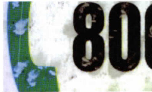
Abb. 2: Scheuerbild unter dem Mikroskop – partielles Abtragen der Druckfarbe bis hin zur Papieroberfläche.
