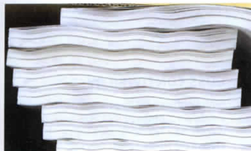
Abb. 1: Durch den Transport verrutschte Lage innerhalb der Palette.
