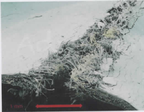
Abb. 2: Falzbrechen im Rollenoffset nach Hitzeinwirkung und Falz (Bildquelle: Fogra-Fehlerkatalog).
