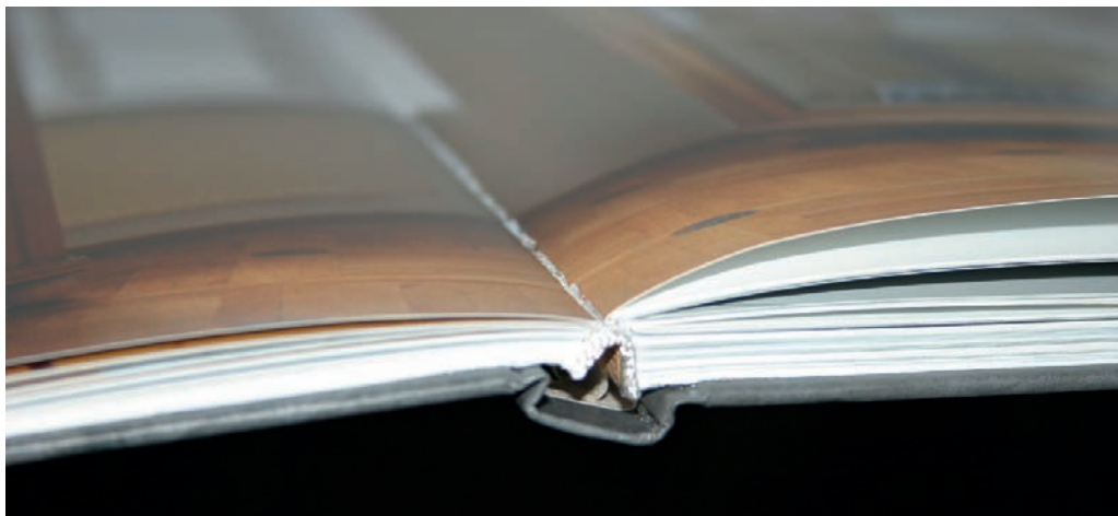
Die Abbildung zeigt einen Deckenband mit brechender Rückenableimung.
