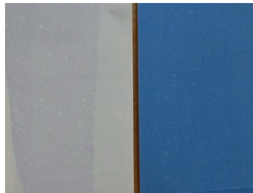
Abbildung 3 zeigt die Gegenüberstellung der punktförmigen Benetzungsstörungen nach dem „Folien-Wischtest“ (links) mit einem Ausschnitt des Auflagedrucks: Hier wird ein übereinstimmendes Erscheinungsbild offensichtlich.
