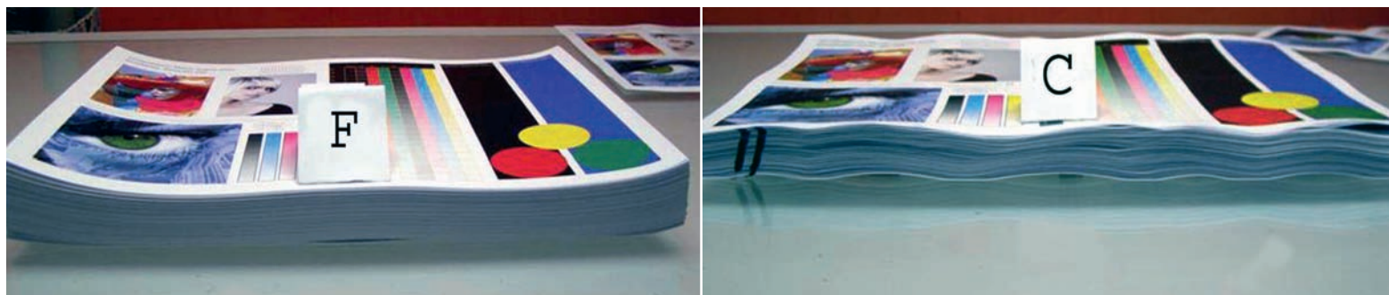
Durch die thermische Belastung des Papiers bei der Heißfixierung können die Druckbogen ihre Planlage verlieren. Durch „Spannungen“ sowie durch den Feuchtigkeitsentzug neigt der Druckbogen häufig zum Tellern (links) oder zur Welligkeit (rechts). In beiden Fällen wird die Druckveredelung und Weiterverarbeitung erschwert.
