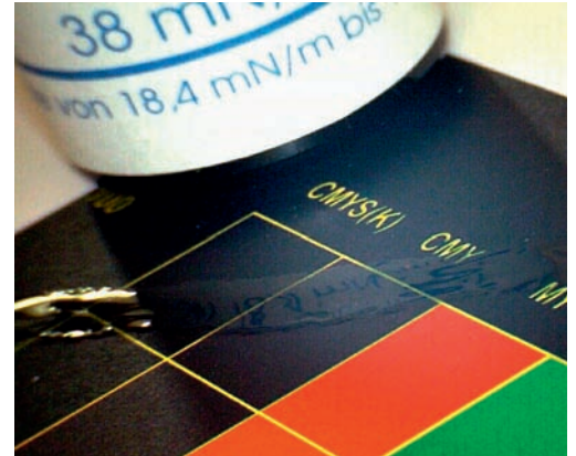
Die Benetzungseigenschaften des Digitaldrucks lassen sich mit Testtinten prüfen. Hier ist das Ergebnis positiv.
