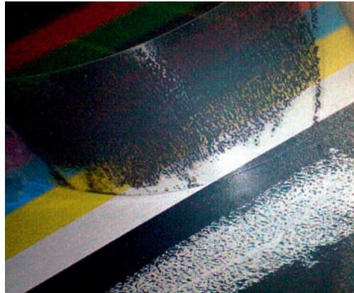
Mit dem Klebebandtest wird geprüft, wie gut die Tonerhaftung ist und ob sich der Bogen verarbeiten lässt.
