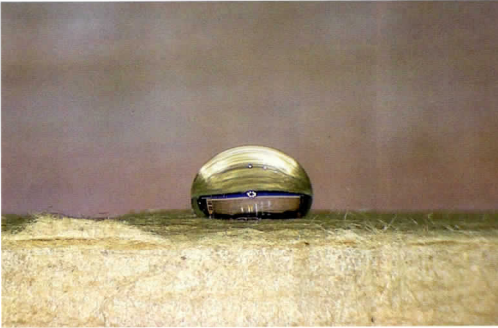
Abbildung 3: Prüfung des Benetzungsverhaltens/Saugverhaltens von Wasser auf dem Hinterklebematerial (Tropfenbildung nach 8 Minuten).
