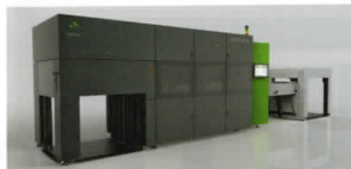
Die Euclid III (Format 76 x 106 cm) ist auch zum digitalen Rillen und Schneiden von Karton und Etiketten (200 bis 600 µm Stärke) geeignet.
