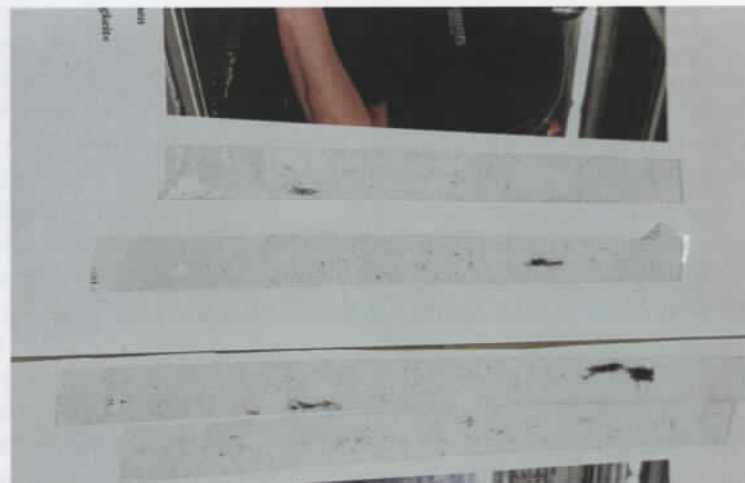
Abbildung 2: Nur geringes Ablösen der Papieroberfläche beim Tesatest am Bogen ohne Aufschäler.
