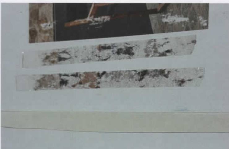
Abbildung 3: Großflächiges Ablösen (Spalten) der Papieroberfläche beim Tesatest am Bogen mit häufigen Aufschälern.
