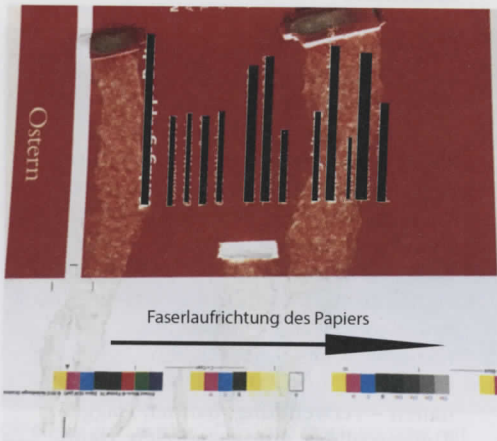
Abbildung 1: Die Aufschäler verlaufen senkrecht zur Papierfaserlaufrichtung.
