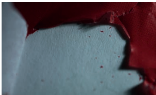
Untersuchung der Kaschier-Folienablösungen: durch die hohen Haftkräfte der Preisetiketten wird die Kaschierfolie mit Farbe und Kartonstrich abgezogen.
