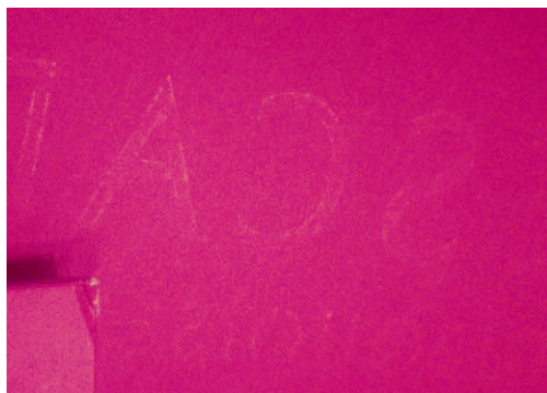
Kontakterscheinungen (Ghosting) einer UV-Spotlackierung im Vollflächen-Rückseitendruck.
