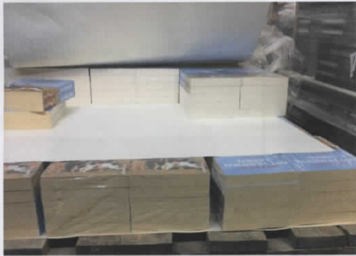
Abbildung 3: Nach Entfernen einer Zwischenlage: oben, geschützter Bereich – kein Vergilben, unten ungeschützt – Vergilben.
