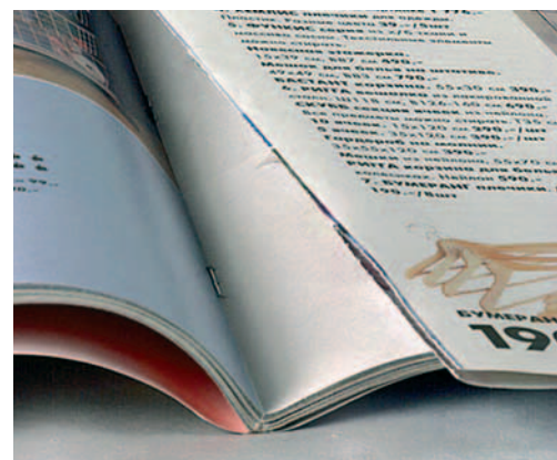
Abbildung 2: Herauslösen des innersten Falzbogens aus der Heftklammer.
