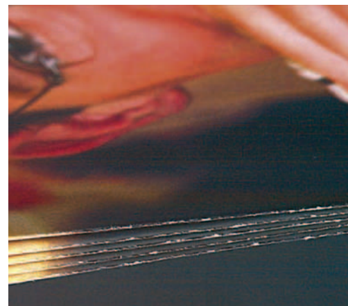
Abbildung 3: Gefalzte Drucke mit dem Problem des Strichbrechens im Falz.
