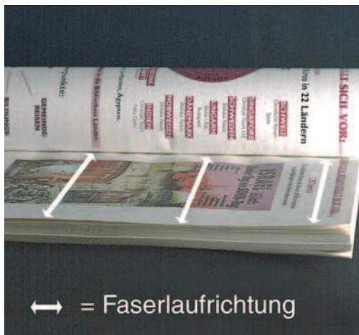
Abbildung 4: Die im Bund fixierte Wellenbildung mit Aufbrechen der Klebebindung. (Bildnachweis: Sämtliche Abbildungen in diesem Beitrag stammen – mit freundlicher Genehmigung – aus dem Fogra-Fehlerkatalog.)
