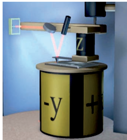
Abbildung 3: Schematische Darstellung des Messprinzips eines Rasterkraftmikroskops.
