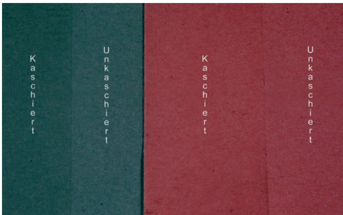
Abbildung 2: Farbunterschiede von verschiedenen Vollflächendruckungen nach der Kaschierung.
