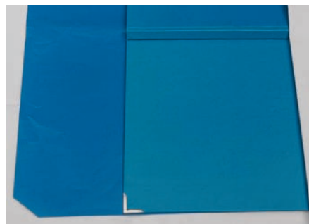
Abbildung 1: Farbveränderungen (Aufhellung) an lackierten Deckenbezügen nach der Deckenherstellung.
